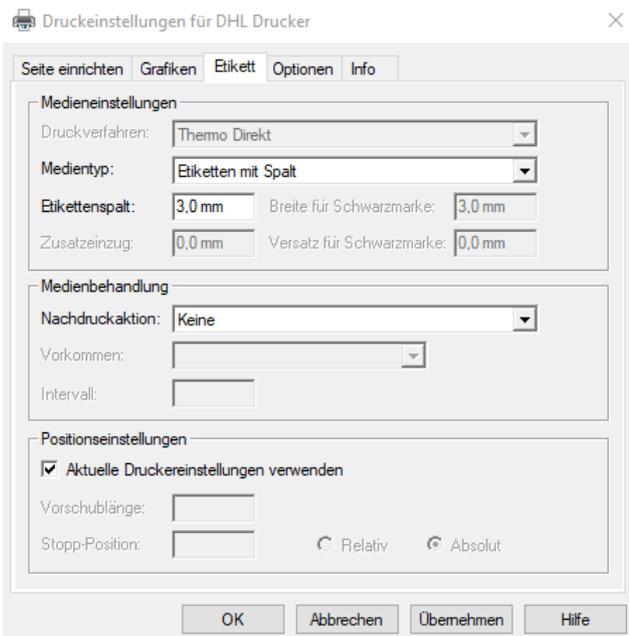
Stellen Sie sicher das Sie bei Medientyp den richtigen Medientyp auswählen. In der Regel sind alle DHL Etiketten „Etiketten mit Spalt“. Im Bereich „Etiketten Spalt“ wird der Abstand zwischen den Etiketten eingegeben - in der Regel wie oben dargestellt 3.0mm. Bei Nachdruck bitte Keine Auswählen und stellen Sie sicher das „Aktuelle Druckereinstellungen verwenden“ angeklickt ist.
