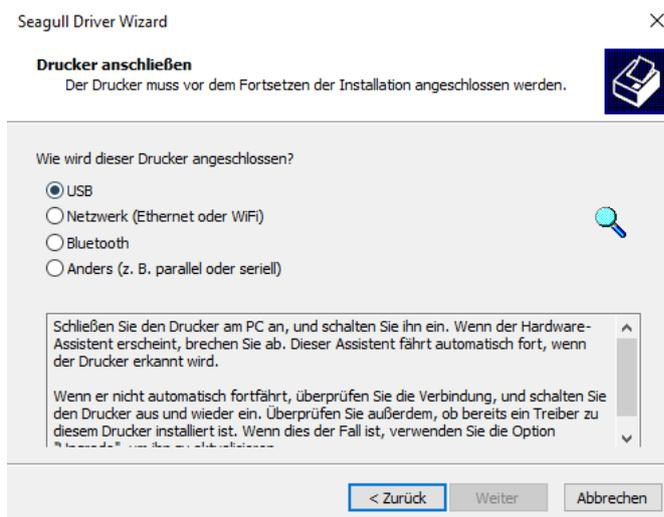
Wenn Sie die richtige Verbindung ausgewählt haben, verbinden Sie den DHL Drucker mit Ihrem Windows PC. Bis jetzt ist die Schaltfläche WEITER > in grau ausgeblendet. Sobald Sie z.B. das USB Kabel bzw. RJ45 Netzkabel mit Ihrem Drucker und PC verbunden haben, schalten Sie den DHL Drucker ein und das folgende Bild erscheint.
